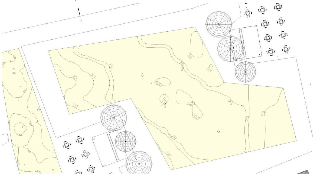
Las luminarias utilizadas serán del tipo vial, tipo 3, tipo 4 o tipo 5, de una potencia aproximada a los 160 W y un flujo luminoso de 22000 lm. También deberán contar con protección contra sobre tensiones del entorno de los 10 kV.
