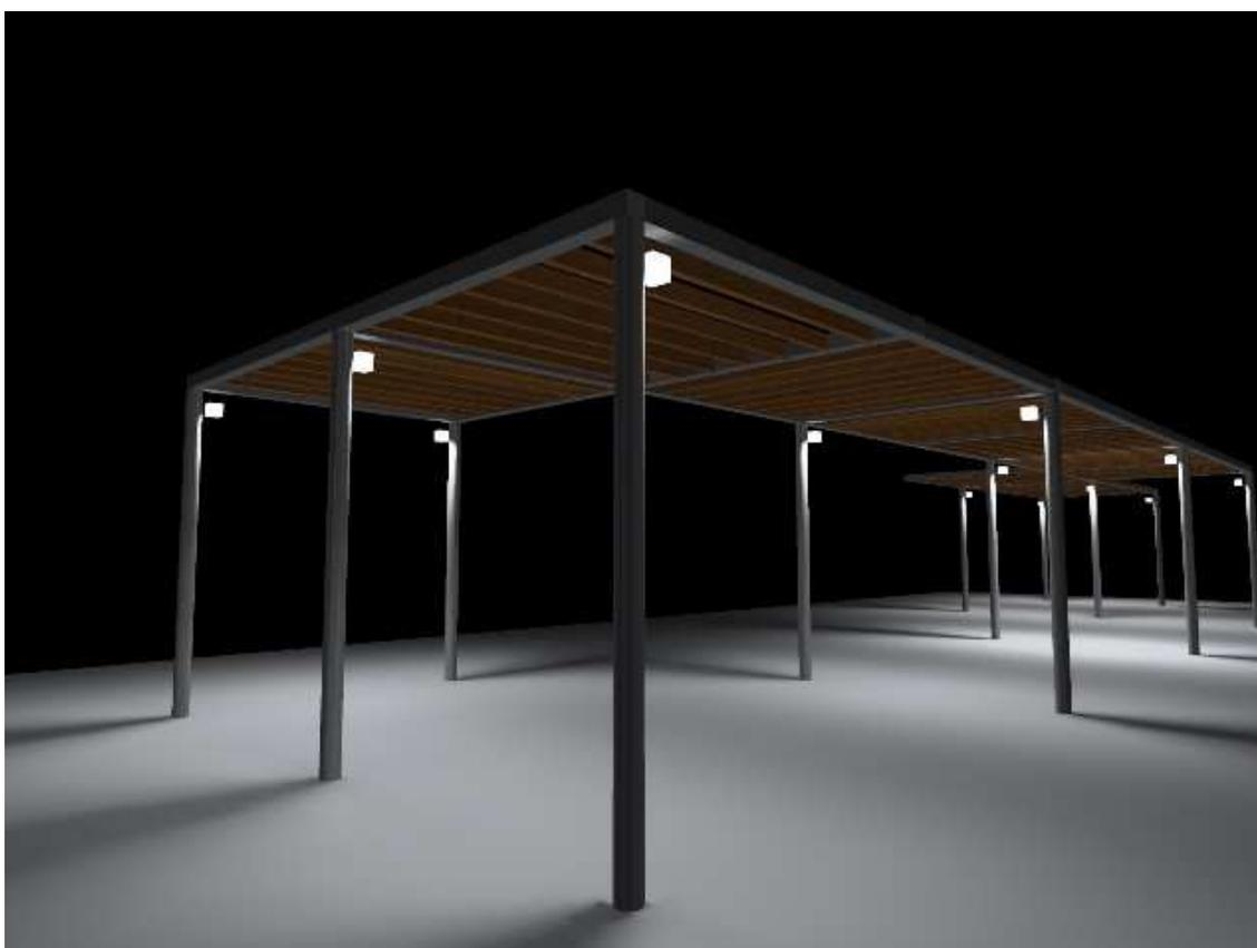
La iluminación en las pérgolas se realizará mediante focos LED tipo Flood Light de una potencia aproximada de 20 W. Los requerimientos lumínicos para este sector son:
