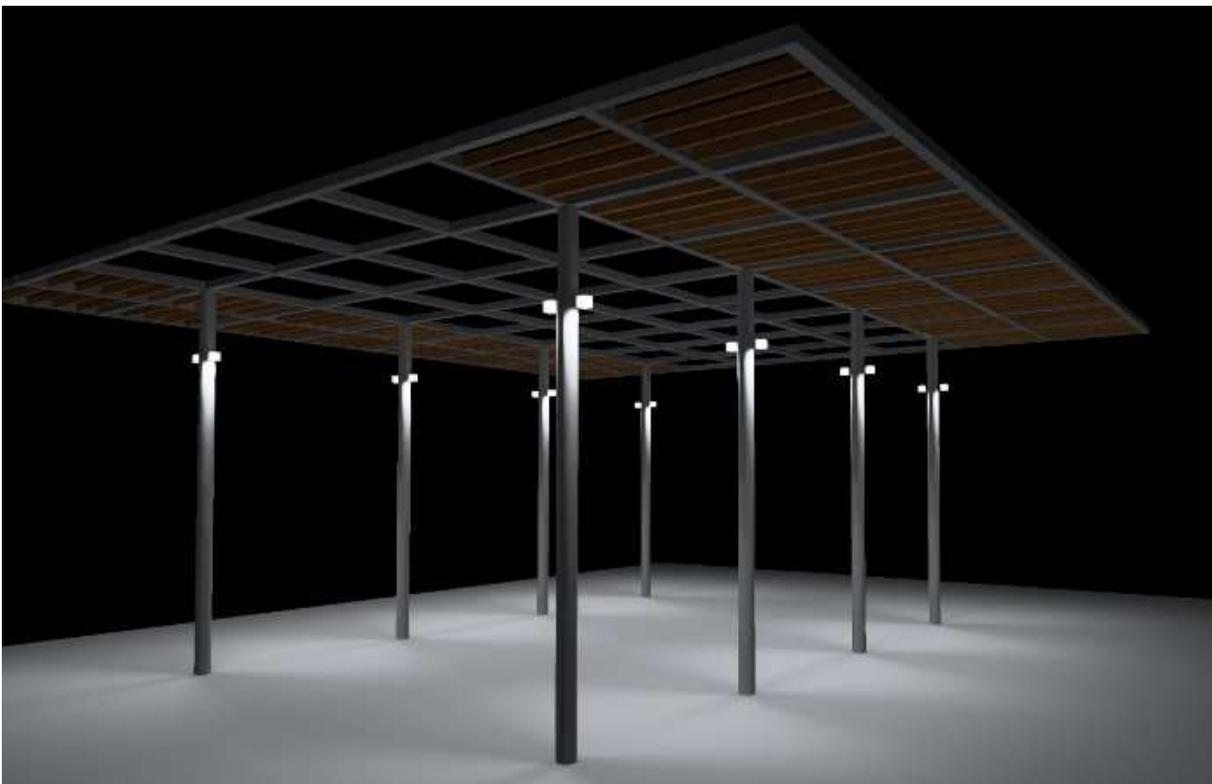
La iluminación en las pérgolas se realizará mediante focos LED tipo Flood Light de una potencia aproximada de 40 W. Los requerimientos lumínicos para este sector son:
