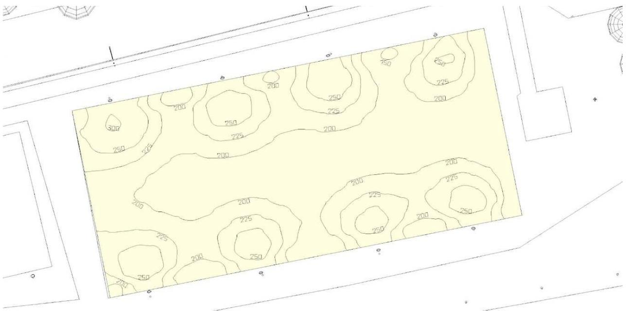
Las luminarias utilizadas serán focos tipo Flood Light o Stadium de una potencia aproximada a los 500 W y un flujo luminoso no menor a 50.000 lm. También deberán contar con protección contra sobre tensiones del entorno de los 10 kV.
